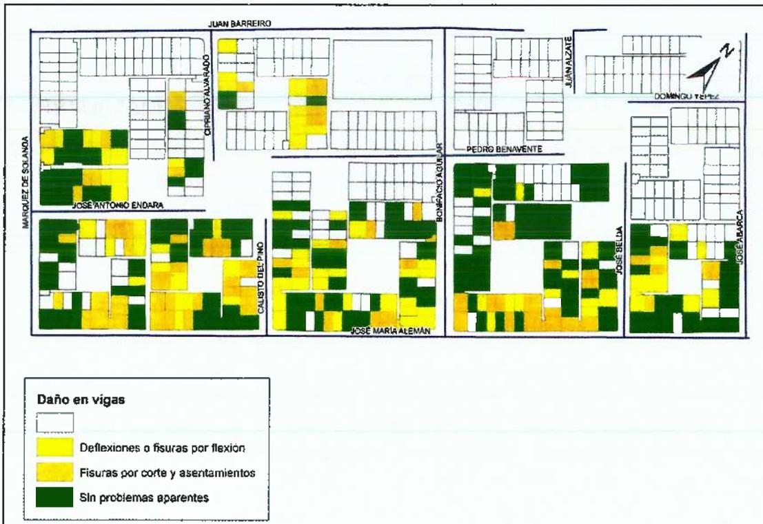
Figura 8: Patología estructural en Viviendas “Diseño de Vigas” / Ciudadela Solanda - Quito
