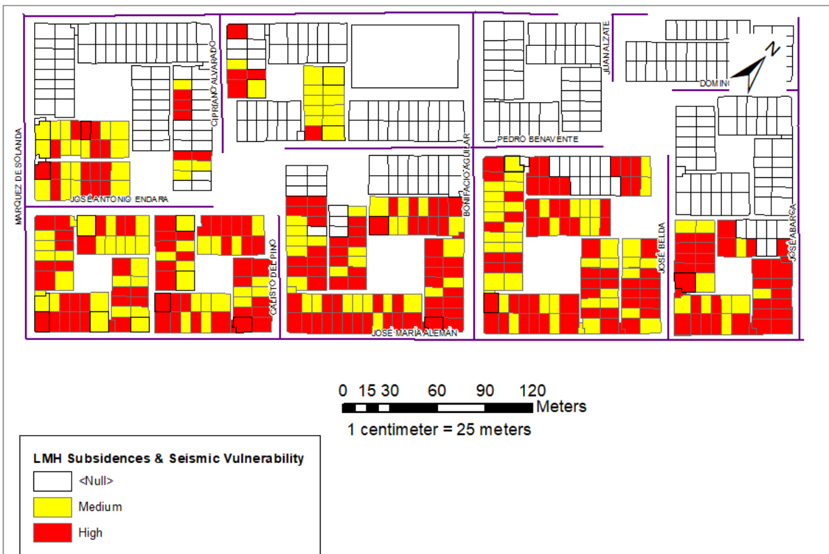
Figura 15: Vulnerabilidad por Sismos en estructuras previamente dañadas por subsidencias
