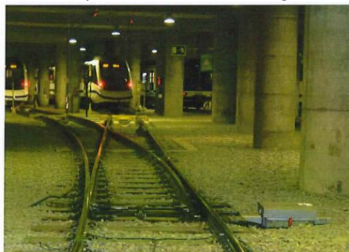
Ejemplo instalación de motores (accionadores) en lateral de vía
